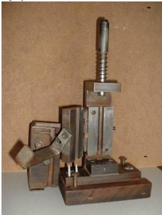
Appareil à sertir les échelles « Made in Tritons »
